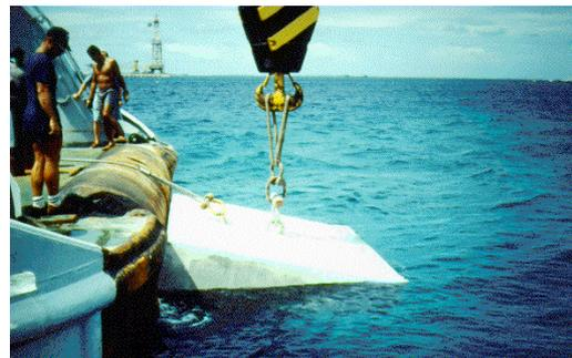
Fig. 13 - Corps-mort, élingué, en appui sur le tableau arrière.
