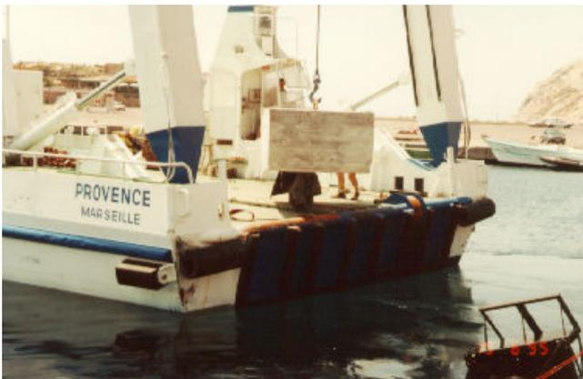
Fig. 12 - Manutention du corps-mort (~12 T) par le portique du baliseur. Celui-ci est saisi par la cigale principale.
