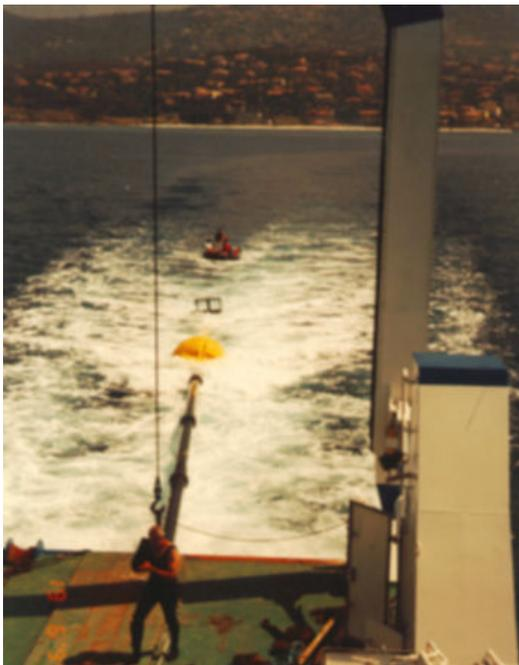
Fig. 16 - Remorquage de la balise vers le lieu de mouillage. Le zodiac maintient la balise dans l'axe longitudinal.
