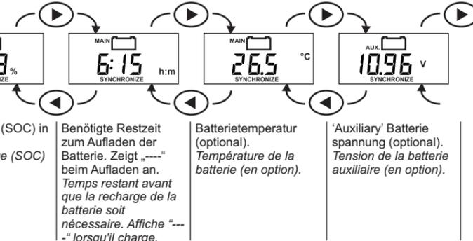
L'affichage indique aussi *SYNCHRONIZE*. Comme il sera expliqué plus loin dans le manuel de l'utilisateur, ce message signifie que la batterie à besoin d'être d'abord complètement chargée afin de synchroniser le moniteur de batterie et la batterie. Sinon, l'affichage de l'état de charge ne sera pas valide. Plus vous chargez la batterie, plus le moniteur de batterie indiquera tous les paramètres les plus précis. Cela permettra aussi d'augmenter la durée de vie de vos batteries.
