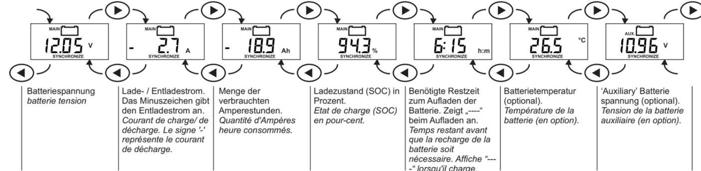
In der Anzeige erscheint ebenfalls *SYNCHRONIZE*. Wie in der Bedienungsanleitung genauer erklärt wird, bedeutet diese Anzeige, dass die Batterie zunächst voll aufgeladen werden muss, um den Batteriemonitor mit der Batterie zu synchronisieren. Andernfalls ist die Anzeige des Ladezustands ungültig. Je häufiger die Batterien vollständig aufgeladen werden, desto genauer zeigt der Batteriemonitor alle Parameter an. Außerdem verlängert dies die Lebensdauer Ihrer Batterien.
