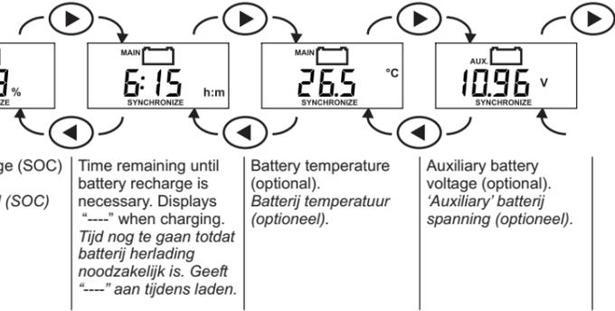
Het display toont tevens de melding *SYNCHRONIZE*. Zoals in de uitgebreidere handleiding zal worden uitgelegd, betekent deze melding dat de batterij eerst volledig opgeladen dient te worden, om de batterij monitor te kunnen synchroniseren met uw batterij. Dit is noodzakelijk voor een correcte laadtoestandsindicatie. Hoe vaker u uw batterij volledig oplaad, hoe nauwkeuriger de batterij monitor u kan voorzien van informatie. Tevens komt dit de levensduur van uw batterij ten goede.
